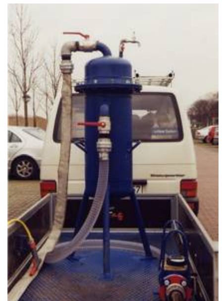
Abbildung 7: Filtrierapparatur zur schonenden Entnahme von Wasserasseln und weiteren Invertebraten aus Hydranten
